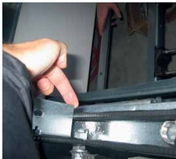
Abb. 8 Scharfkantige Bleche im Montagebereich
